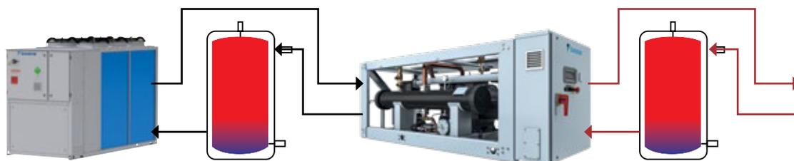
\* Evaporador 45°C/40°C; Condensador 75°C com DT até 20K
